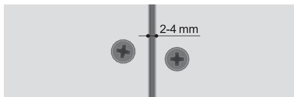
Dans le cas d'une cloison double peau, les joints de plaques de plâtre de la première peau devront être également traités avec PENOSIL Jointaplac 650.
