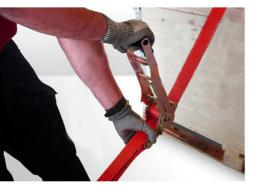
Le serrage en tirant vers soi avec une poignée plus longue rend la mise en tension plus ergonomique, rapide et facile.
